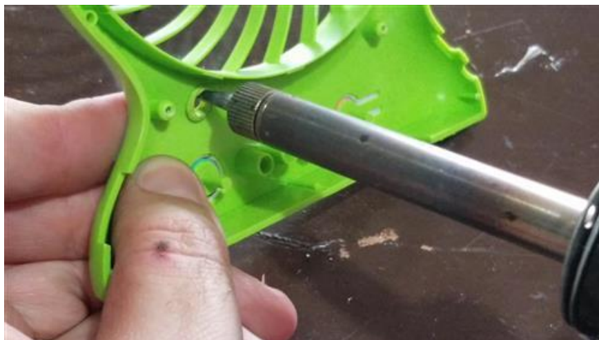
Abrimos hueco para colocar el adaptador de 3.5mm hembra tipo caja
